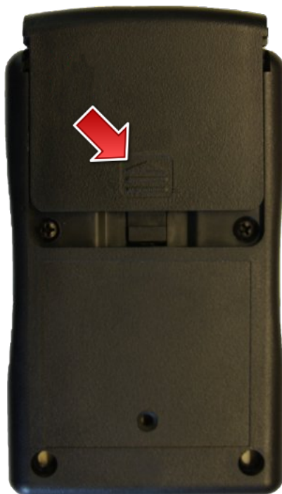
Rys. TachoReader Combo Plus - wymiana baterii.
